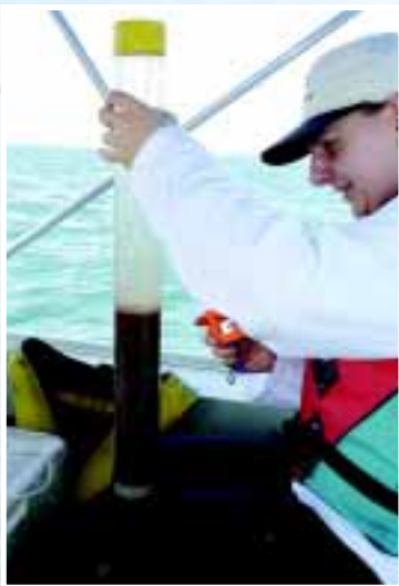
Detalhe da coleta de sedimentos de fundo do Reservatório de Itumbiara (MG/GO)
