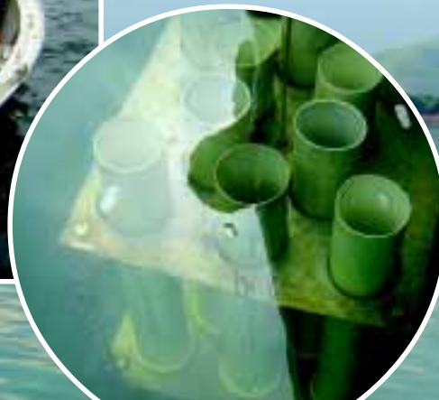
Coletor utilizado para medir a quantidade de sedimentos que chegam ao fundo do reservatório
