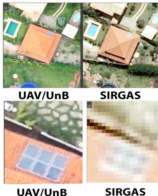
Figura 1 – Comparação visual entre as resoluções espaciais dos ortomosaicos SIRGAS (1 metro) e do VANT/UnB (6 cm).
