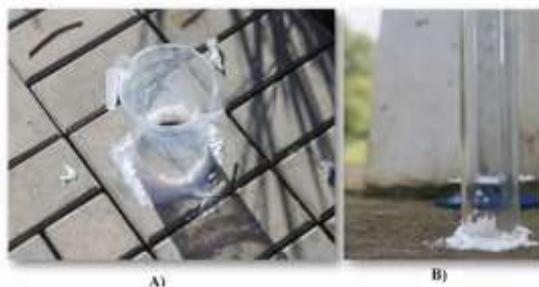
**Figura 2.** Instrumentos utilizados nos ensaios de permeabilidade, para área basal maior buscando compreender uma maior área para a permeabilidade (Figura 1-A) e outro para área basal menor para superfícies homogêneas (Figura 1-B).
