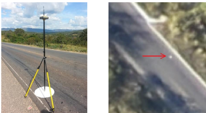
Figura 2. Alvo pré-sinalizado sendo rastreado e seu homólogo na fotografia aérea.
