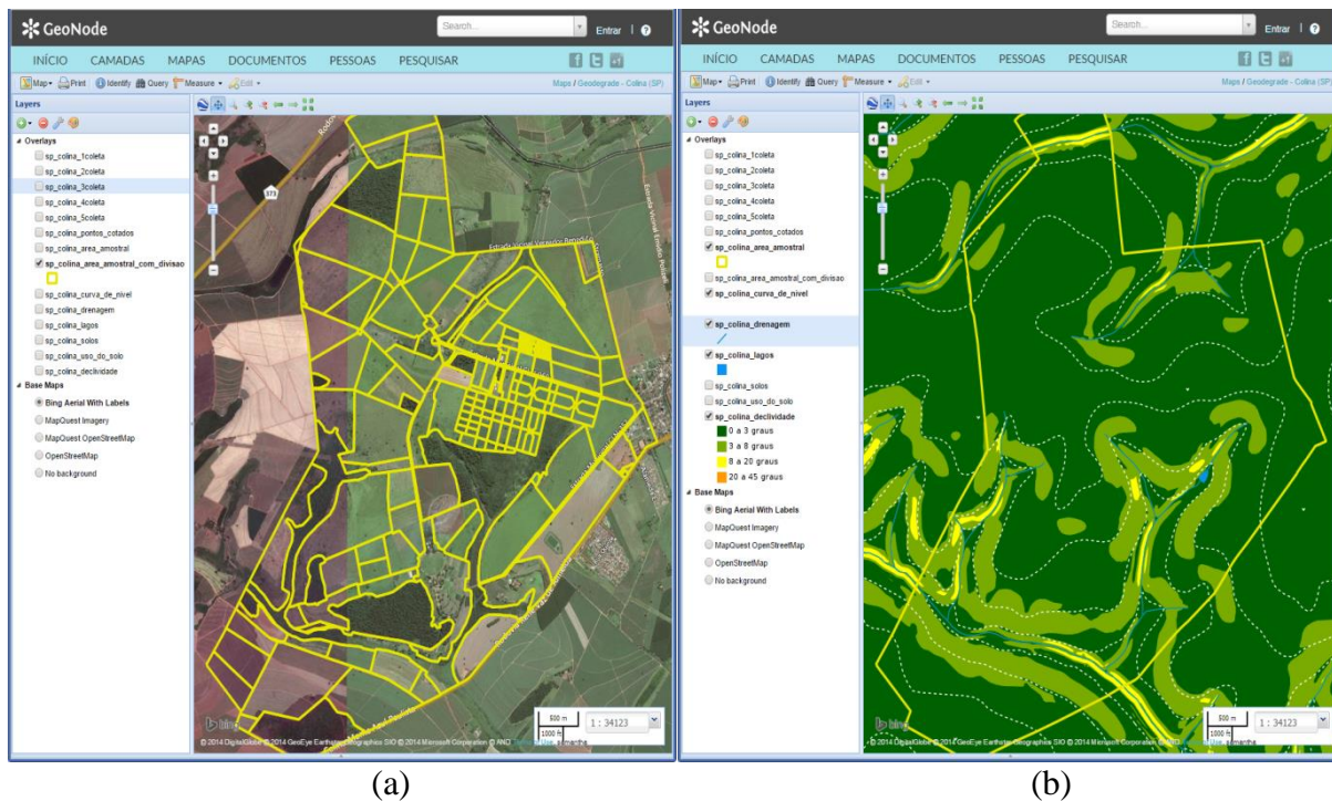
Figura 6. Exemplos de sobreposição dos planos de informação das divisões internas (a) e de declividade (b), adquiridos da área de estudo localizada em Colina-SP.
