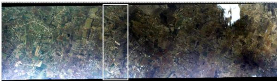
Figura 1. Um segmento de faixa da câmera ADS-80 aberto no Erdas. O retângulo branco mostra o recorte usado nos processamentos. (Cortesia do 1º/6º GAV)
