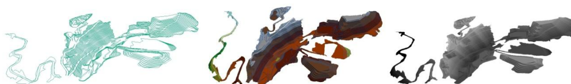
Figura 4. Processo de modelagem 3D - Vetor, TIN e Raster.
