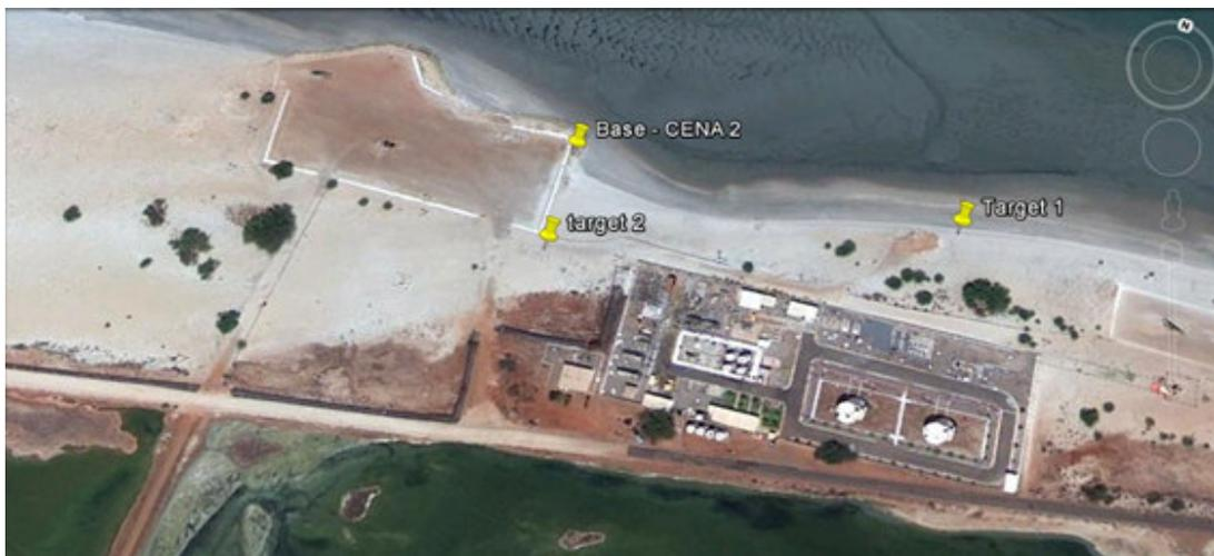
Figura 2 – Vista geral do trecho da praia de Soledade imageado com LiDAR Terrestre (LT), nas imediações da base de extração petrolífera Macau-A com detalhe do arranjo geométrico entre local de instalação do LT/base robótica e dos alvos (*targets*) 1 e 2, para cobertura da cena imageada e georreferenciamento. Fonte: Imagem Google Earth
