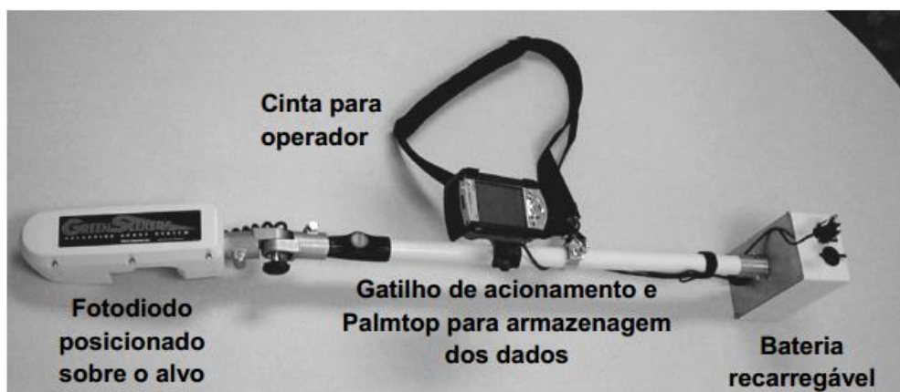
Figura 2. Sensor ativo Green Seeker , com os seus componentes. Adaptado de GROHS, 2008.
