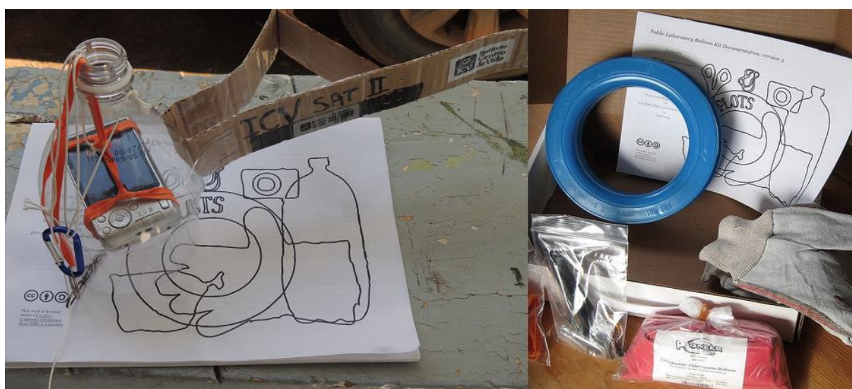
Figura 1. A direita, foto dos itens do kit do balão comercializado pelo Public Lab . A esquerda, foto que apresenta câmera acoplada a garrafa pet e estrutura aerodinâmica feita de papelão.
