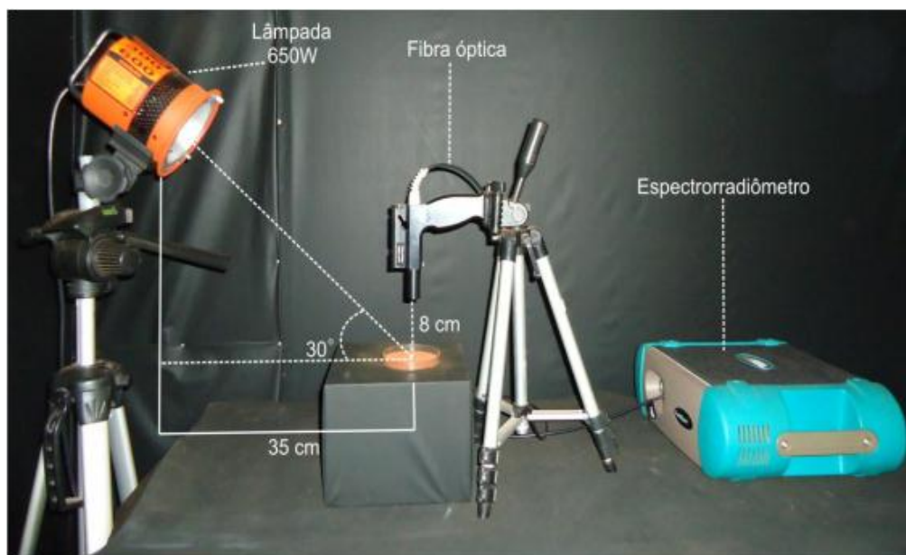
Figura 1. Disposição e geometria do equipamento FieldSpec para obtenção dos dados espectrais das amostras.
