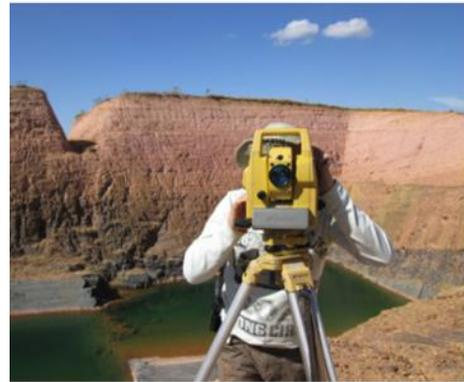
Figura 7 – Levantamento utilizando estação total.
