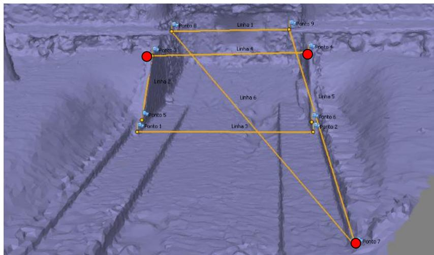
Figura 13 - Modelo SfM gerado. Em vermelho, pontos utilizados na geração do modelo.
