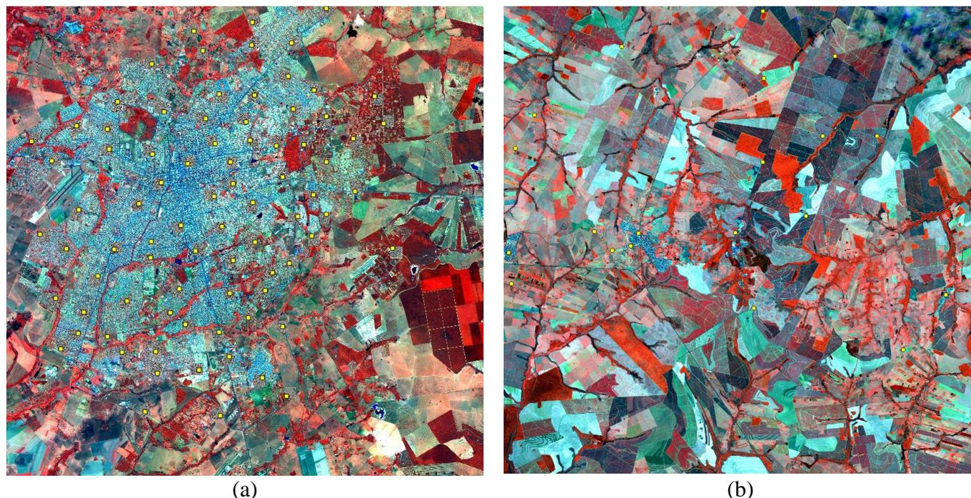
Figura 1. Distribuição dos pontos de verificação nas ortoimagens RapidEye (Geo Catálogo MMA): (a) Imagem que engloba a área urbana de Campo Grande/MS; (b) Imagem da região que engloba a área urbana de João Ramalho/SP.
