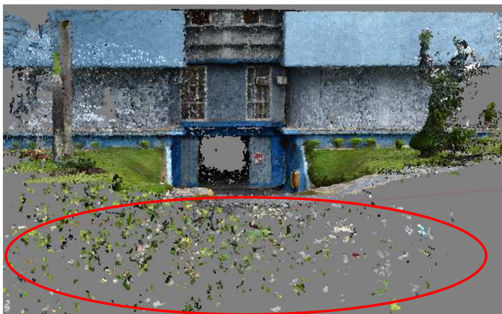
Figura 8 – Modelo gerado a partir do uso de 32 fotografias com resolução de 2000 x 1500 pixels. Área destacada mostra presença de pontos posicionados de forma errônea no modelo.
