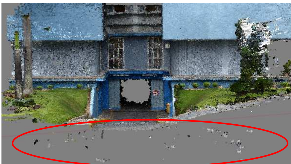
Figura 7 – Modelo gerado a partir do uso de 32 fotografias com resolução de 4000 x 3000 pixels. Área destacada mostra presença de pontos posicionados de forma errônea no modelo.
