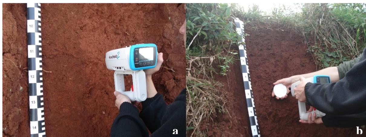
Figura 2. Mensuração da reflectância *in situ* e calibração do aparelho espectrorradiômetro.
