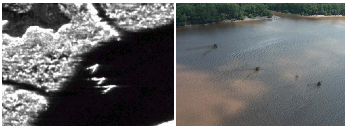
Figura 4. Na imagem SAR é possível perceber três armadilhas de pesca, alinhadas lateralmente, e a imagem da direita permitiu identificá-las como sendo do tipo curral de enfia. Fonte: Centro Gestor e Operacional do Sistema de Proteção da Amazônia (2006).
