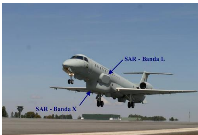
Figura 1. Localização das antenas das Bandas L e X do SAR R-99.
