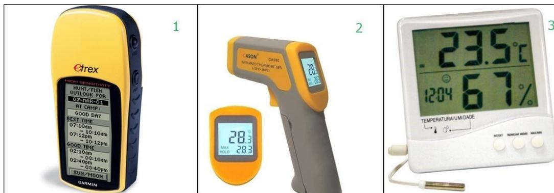
Figura 2: GPS Garmim EtrexH (1); Termômetro infravermelho com mira a laser CASON CA380 (2) e Termohigrômetro digital INCOTERM/7663 (3).
