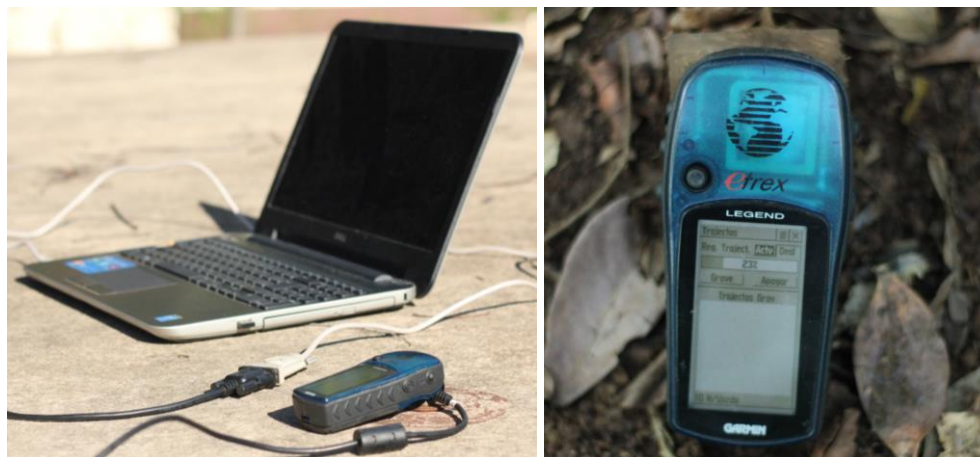
Imagem 1 e 2: A imagem 1, à esquerda, mostra o sistema para coleta de dados na estação base. Nela é possível observar os 3 equipamentos fundamentais: receptor GPS, computador e cabo conversor USB-SERIAL. A imagem 2, à direita, apresenta um receptor GPS móvel coletando dados em área florestal simultaneamente ao receptor da estação-base
